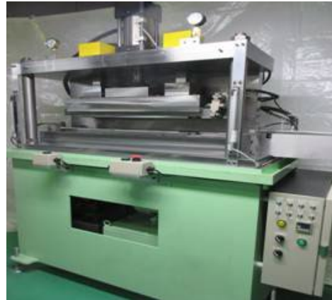
IHX 二重螺旋管用専用プレス機
