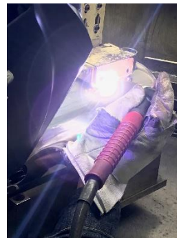
工場内（TIG溶接）
